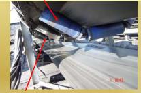
Roller เหล็กน้ำหนักประมาณ 38 kg
