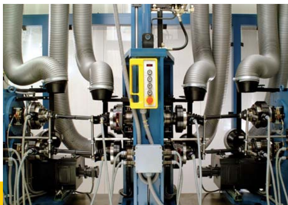
BECHEM Gelenkwellenprüfstand, im Werk Hagen BECHEM CV-joint test bench, plant Hagen
