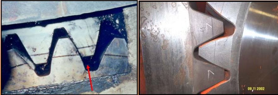
ชุดเฟืองขับมีช่องว่างโคนฟันมากเกินไป
