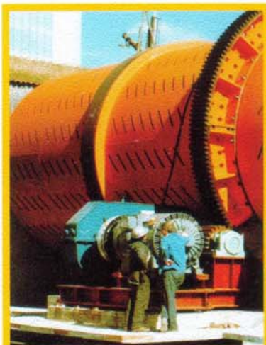
Offener Antrieb eines Drehrohrofens Open gear drive of a rotary kiln
