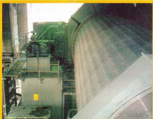
Direktantrieb einer Kugelmühle Direct meshing gear drive of a ball mill
