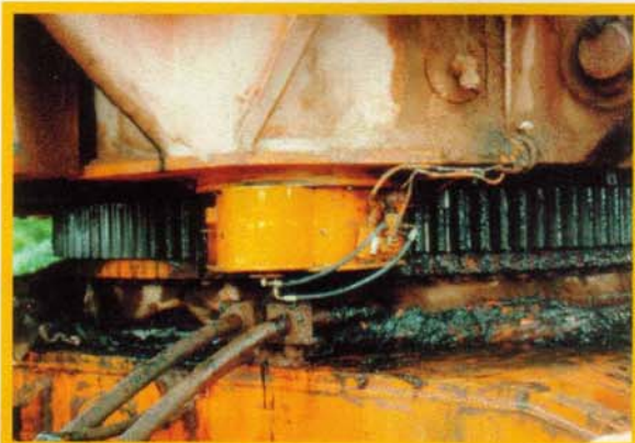
Drehkranz eines hydraulischen Baggers Slew ring gear drive of a hydraulic excavator
